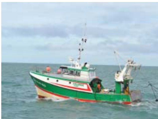
Long de treize mètres, le Sauvage permet de pêcher à la drague jusqu'à 1,5 tonnes de coquilles Saint-Jacques.
