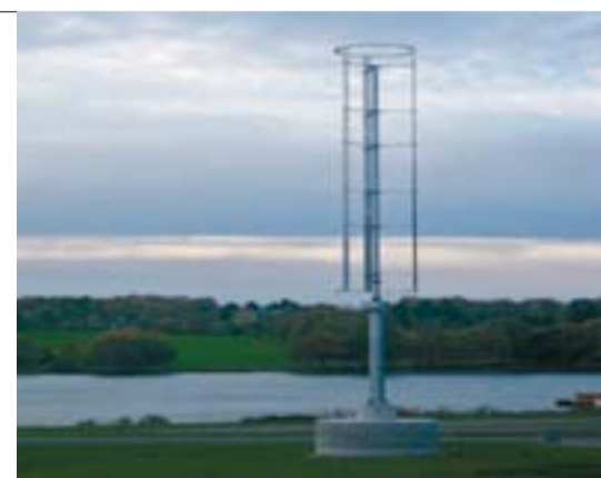
L'éolienne résidentielle Windspire de la société Les Moissonneurs du ciel.
