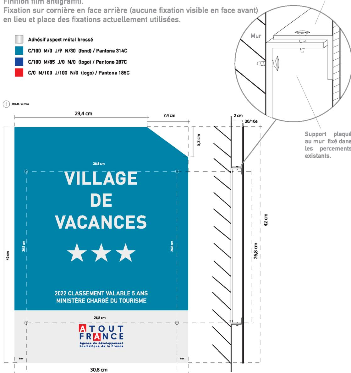
Support plaqué au mur fixé dans les percements existants.
