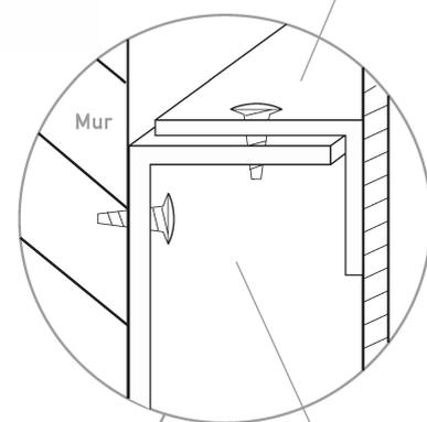
Support plaqué au mur fixé dans les percements existants.
